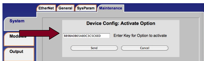
Abb.: Eingabe von Schlüsseln zur Freigabe von Hardware-Optionen
